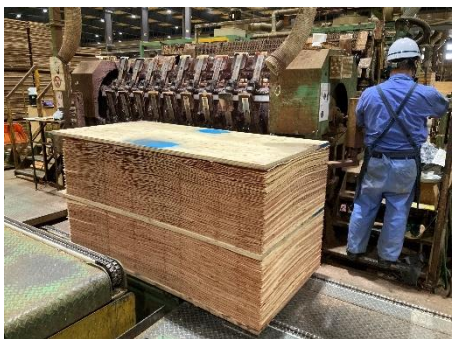
両面に接着剤を塗布した中板に単板を重ね、貼り合わせる
