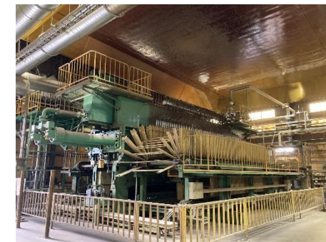
130℃のホットプレスで熱硬化
