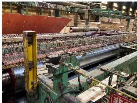
スプレッターを通じて中板の両面に接着剤を自動塗布
