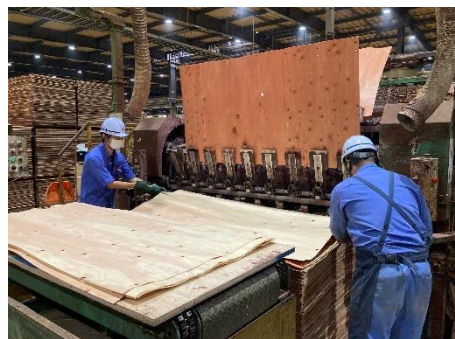
両面に接着剤を塗布した中板に単板を重ね、貼り合わせる
