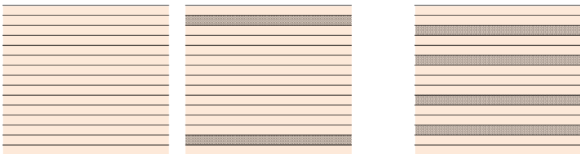
A 種 LVL（全て平行層、又は、 最外層の 1 つ内側が直交層）
