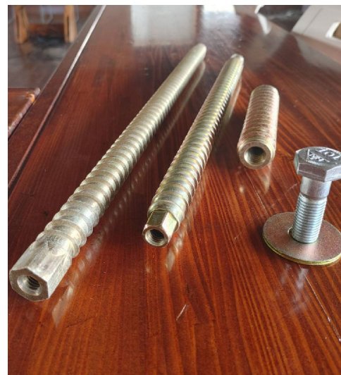
図 8.7 雌ねじ加工を施した LSB の例
