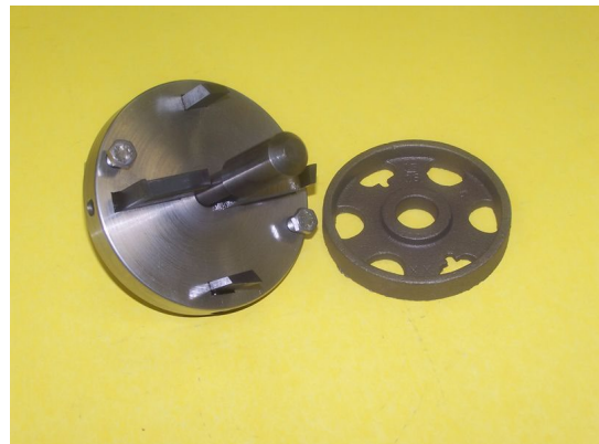
図 17.4 シアプレートと彫り込み加工具
