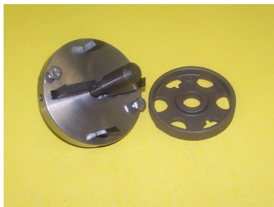
図 17.4 シアプレートと彫り込み加工具
