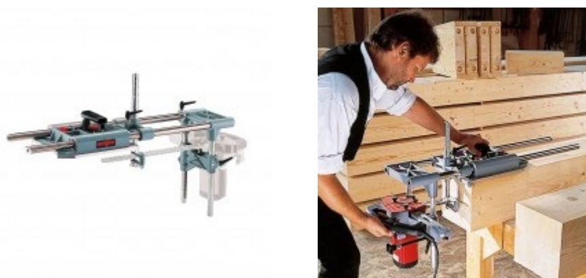
図 17.2 スリット加工機（Mafell 社製）の例
