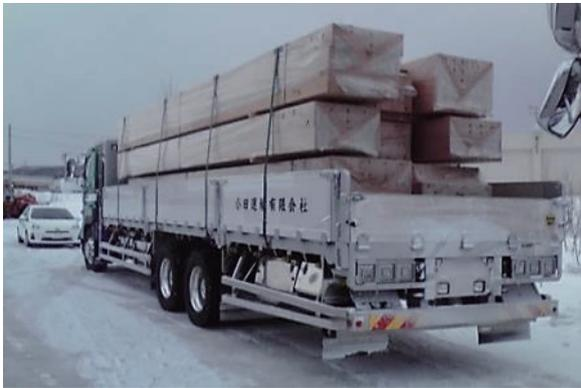
図 3.4 荷崩れを防止する処置
