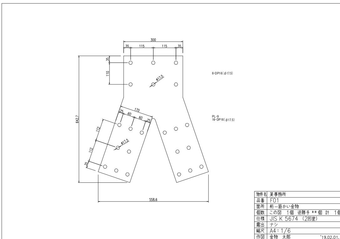
図 5.3 F型金物（平板金物）の製作図の例
