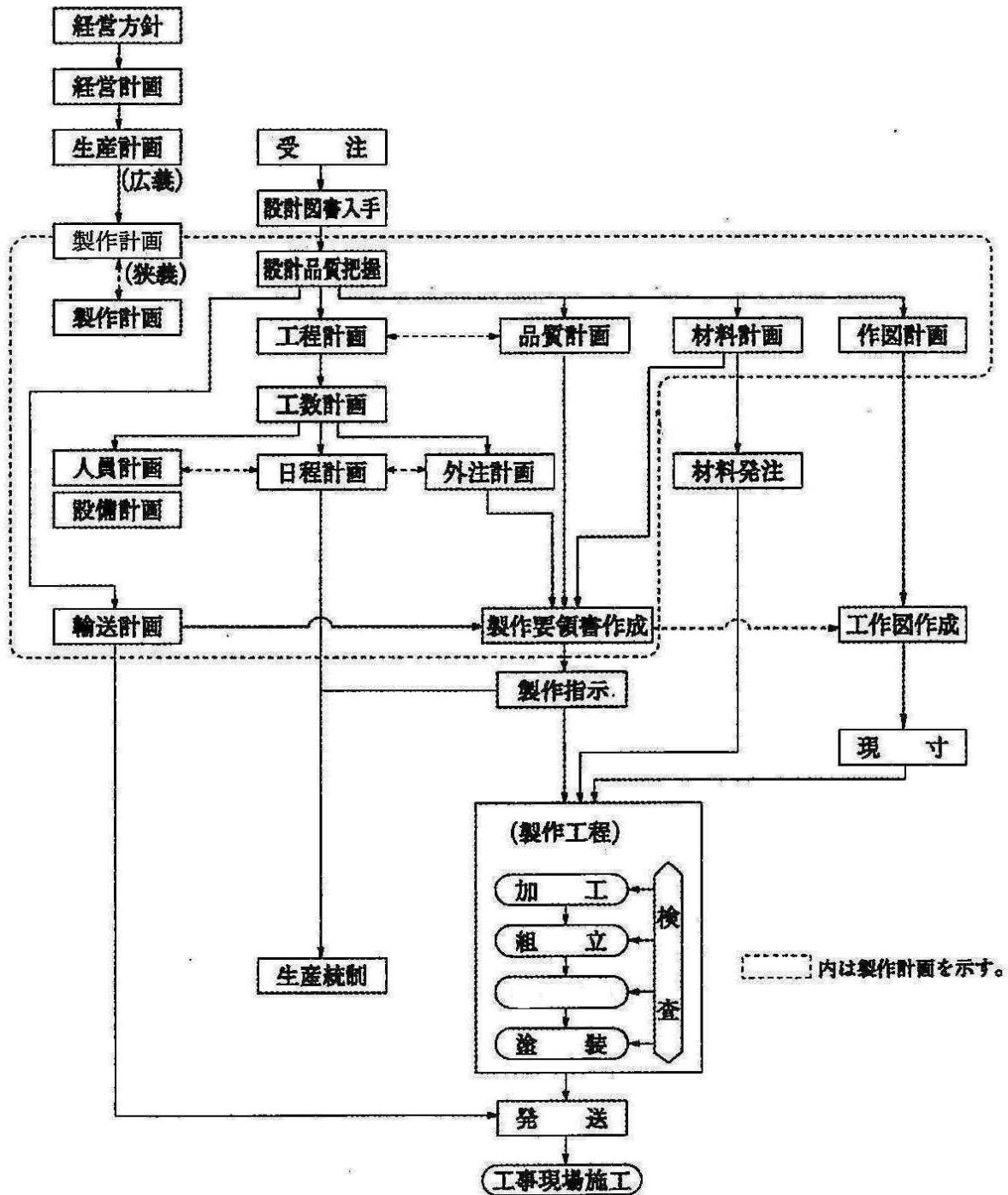
図 2.1 木質構造部材生産の流れ
