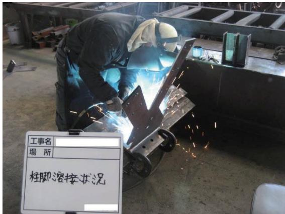
図 5.8 柱脚金物の溶接
