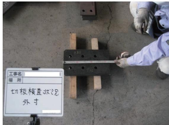
図 5.5 切板の外寸検査
