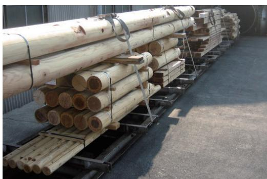
図 6.8 加圧処理法による木材の薬剤処理
