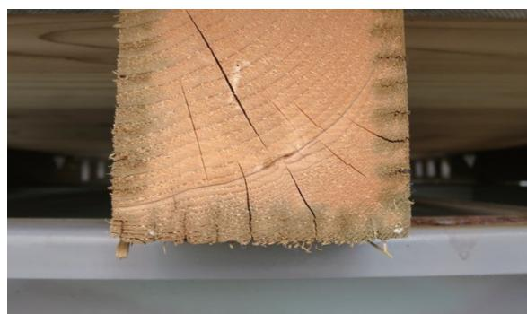
図 6.9 インサイジングにより薬剤処理した木材の断面
