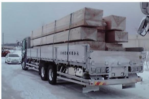
図3.4 荷崩れを防止する処置
