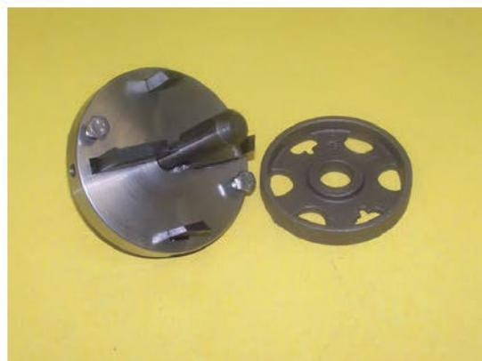
図4.4 シアプレートと彫り込み加工工具
