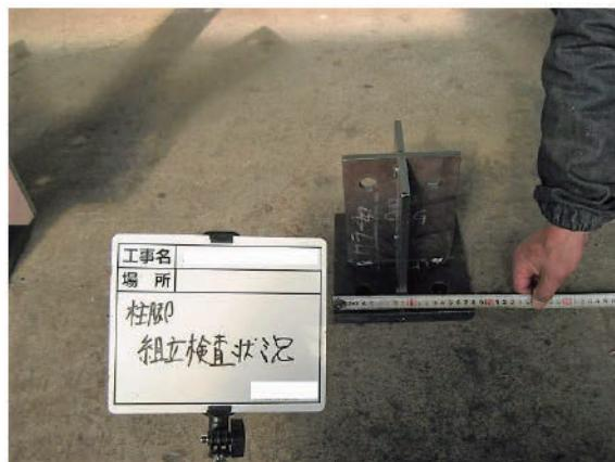
図 5.7 組立ての精度検査
