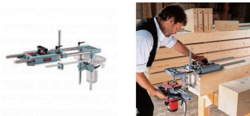
図4.2 スリット加工機（Mafell社製）の例
