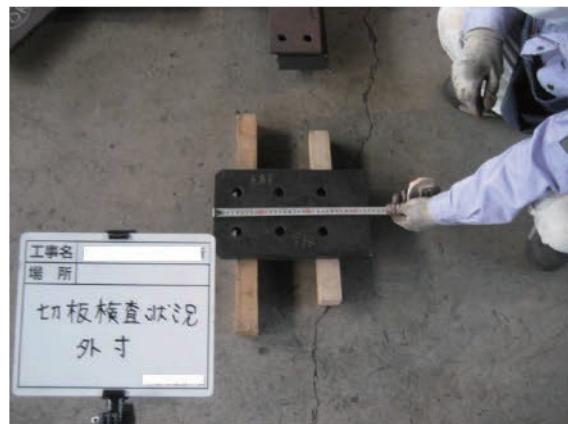
図 5.5 切板の外寸検査
