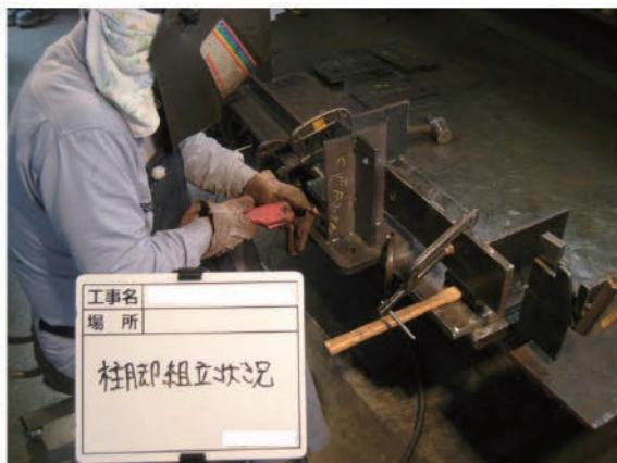
図 5.6 柱脚金物の組立て
