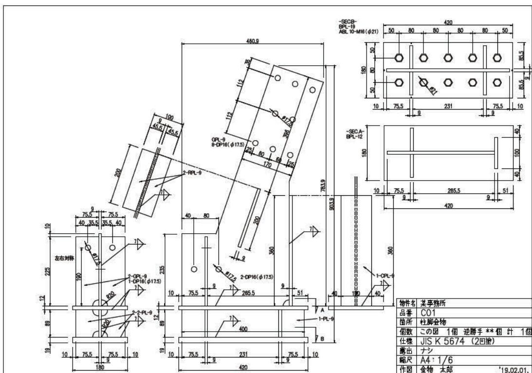
図 5.1 柱脚金物の製作図の例
