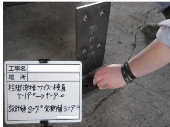
図 5.9 溶接サイズ検査
