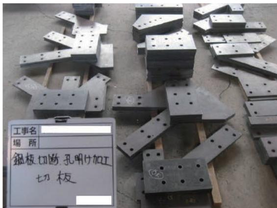
図 5.4 切断孔あけ後の切板
