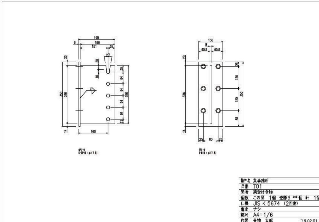
図 5.2 T型金物（仕口金物）の製作図の例
