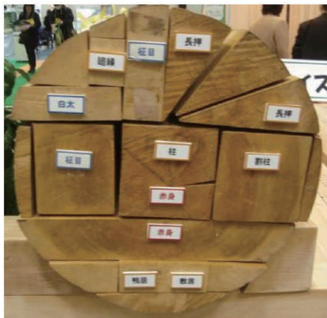
図 7.3 木取りによる断面変形の事例
