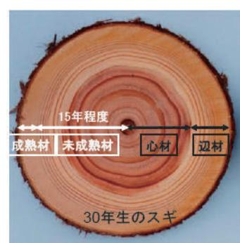
図 1.5 心材・辺材と成熟材・未成熟材<sup>2)</sup>
