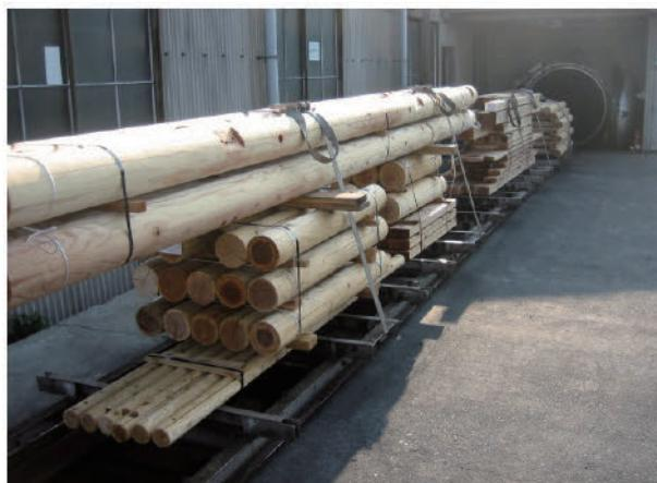
図 6.8 加圧処理法による木材の薬剤処理
