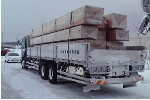
図 22.4 荷崩れを防止する処置
