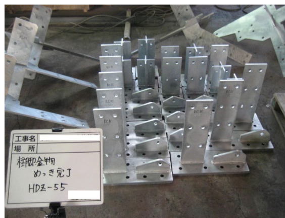
図 18.13 めっき後の製作金物
