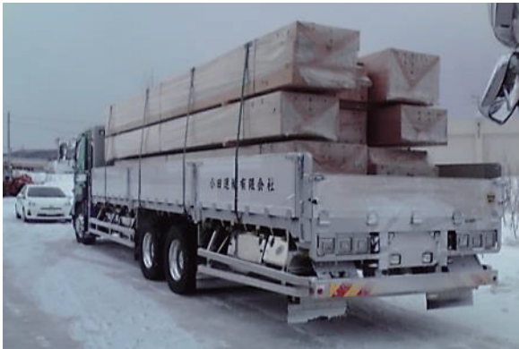
図 3.4 荷崩れを防止する処置
