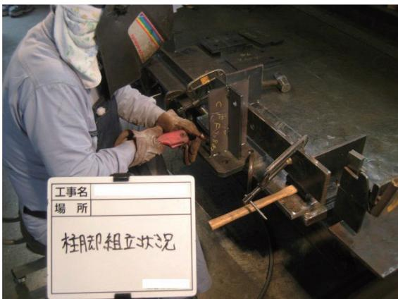
図 5.6 柱脚金物の組立て
