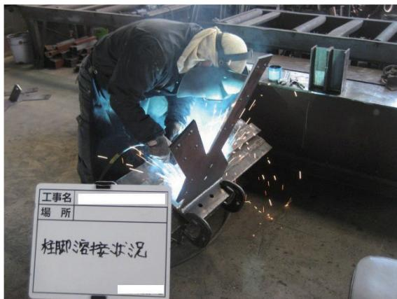
図 5.8 柱脚金物の溶接
