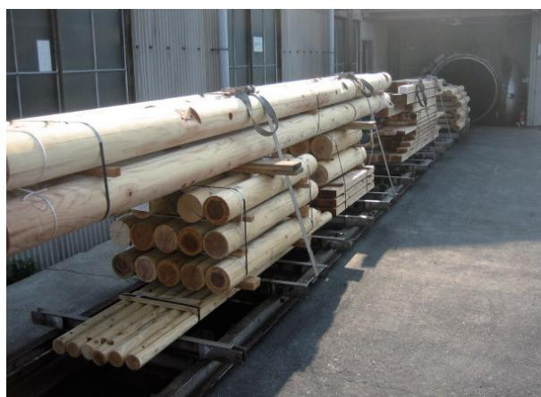
図 6.8 加圧処理法による
