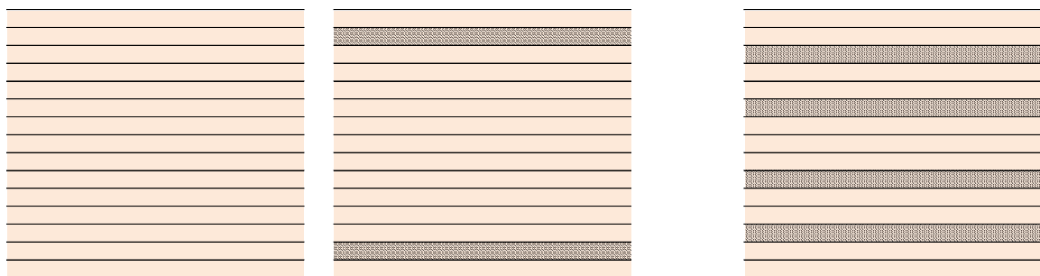
A 種 LVL（全て平行層、又は、 最外層の 1 つ内側が直交層）
