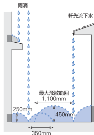
図 6.8 跳ね返り雨水による足元の濡れ 2)
