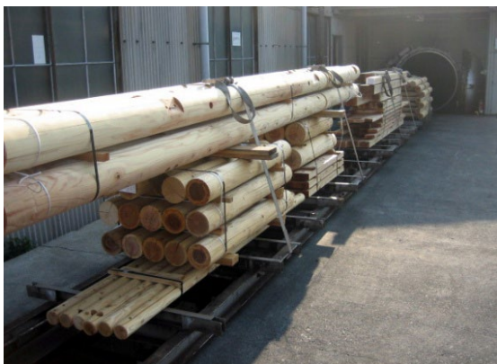
図 6.9 加圧処理法による木材の薬剤処理
