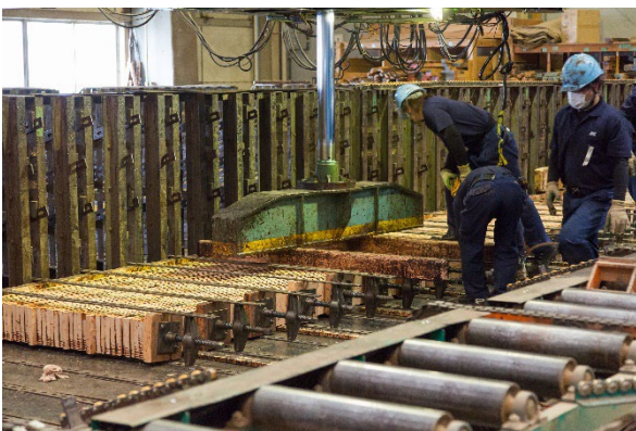
大断面集成材の製造風景 (人力)
